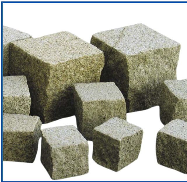
Granitpflaster gelb, Oberfläche gesägt und gestockt 9x9x9 cm / 16x16x16-22 cm
